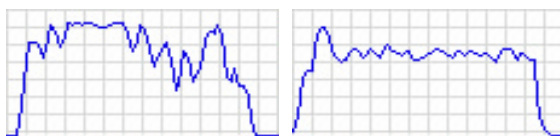
圖表 7: 左圖為使用非平順排程的使用頻寬變化圖; 右圖為使用我們實作的平順排程演化法的使用頻寬變化圖。
