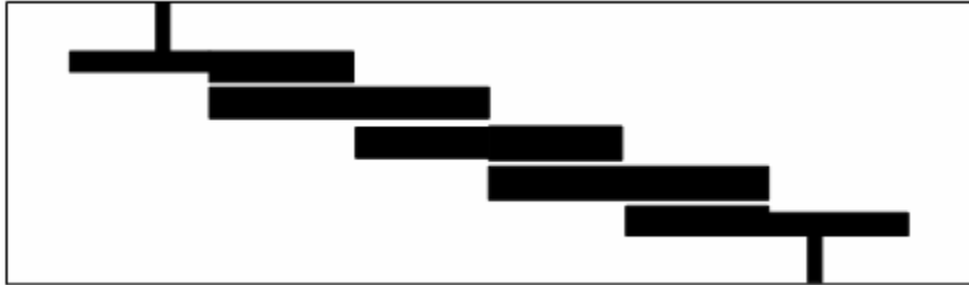
圖十四. 毫米波平行耦合型帶通濾波器之佈局圖。
