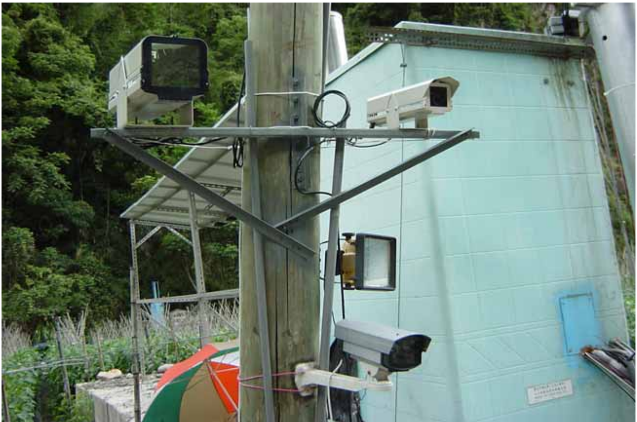
圖 2.6 第一套 CCD 與照明設備裝置於小屋旁，雨量計在屋頂。
