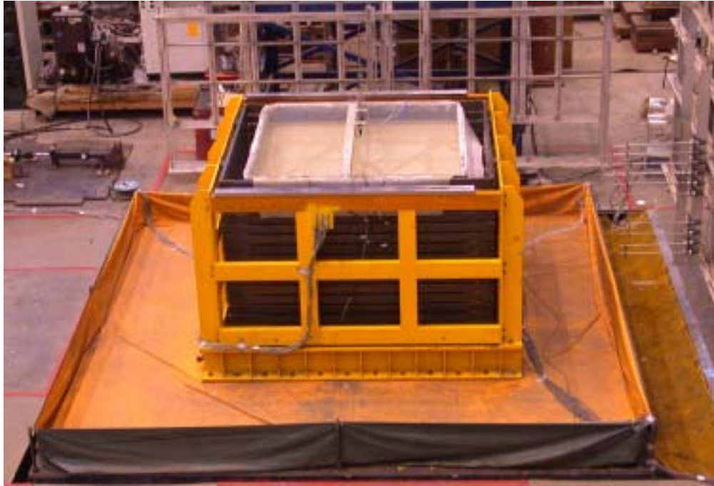
圖五 振動台大型剪力盒試體試驗
