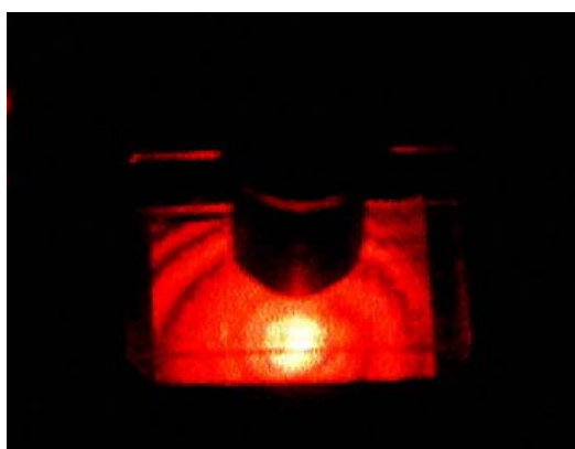
圖 2-2：以正立式差動共焦顯微鏡結光鉗捕捉小球時的散射光投影照片。
