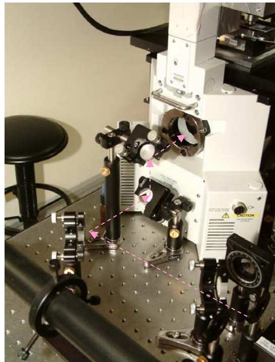
圖 2-7：紅外線雷射光束經擴束與抬升後，由後光埠導入至物鏡處聚焦。
