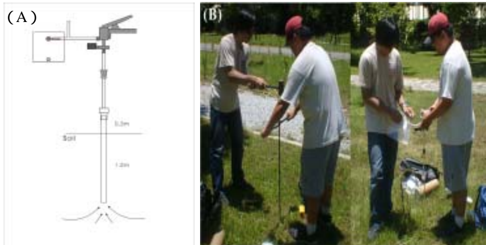
圖五 (A) 土壤氣體採樣示意圖；(B) 野外採樣土壤氣體的實際情形。
