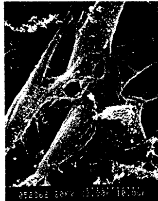
圖 15 SEM ( \times 3000 ) 觀察細胞在 CS/PU=7/3 膜上培養 72 小時的結果
