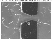
(b) 鎳金屬微噴嘴結構 圖五 光學顯微鏡觀察圖
