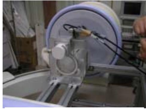
圖六、驗證實驗裝置，包括旋轉盤本體及獨立支架。中央圓筒可置入人工膝關節組件，用以確認相對誤差。
