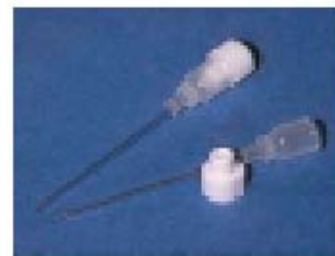
圖 5-16 Real-Time PCR 專用 20µl 玻璃毛細管
