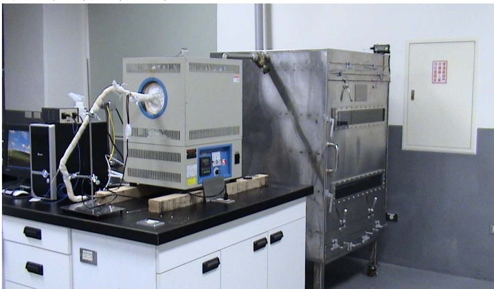
圖1-1 奈米氧化鋅產生系統全貌
