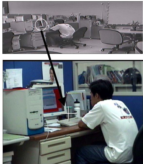
圖二：上圖為廣角攝影機所看到的畫面以及其所使用的校正控制點。下圖為某一個校正控制點之下 PTZ 攝影機所對準的畫面。
