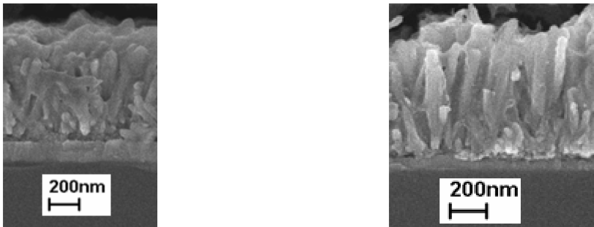
圖 38(a) 場發射掃描電子顯微鏡之有額外 PCBM 覆蓋的氧化鋅奈米線層剖面圖 (b) 無額外 PCBM 覆蓋的氧化鋅奈米線層剖面圖
