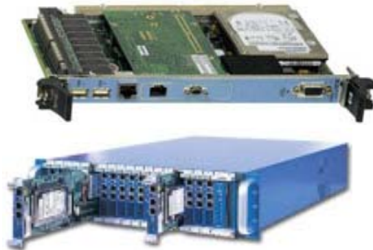
圖 1、刀鋒式伺服器--- (A) 刀鋒部分、(B) 伺服器主機。
