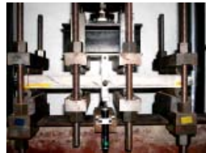
圖 3 反覆循環彎矩試驗
