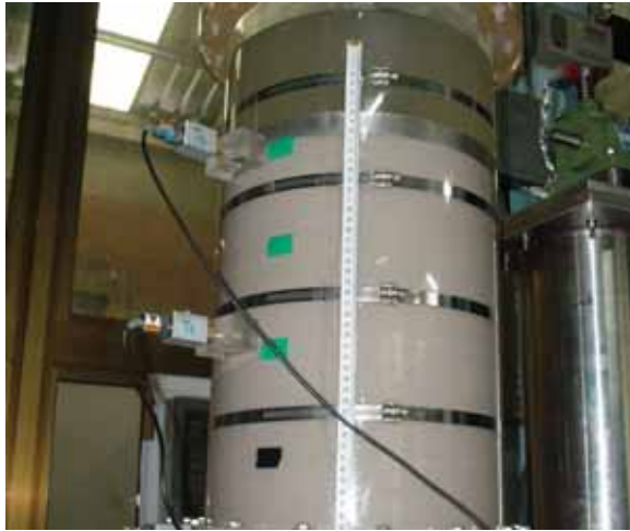
圖 7 雙向水流試驗之試體填築情形
