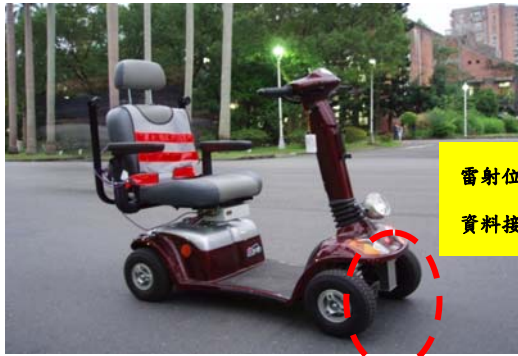
圖 4 鋸槽幾何尺寸自動化量測設備
