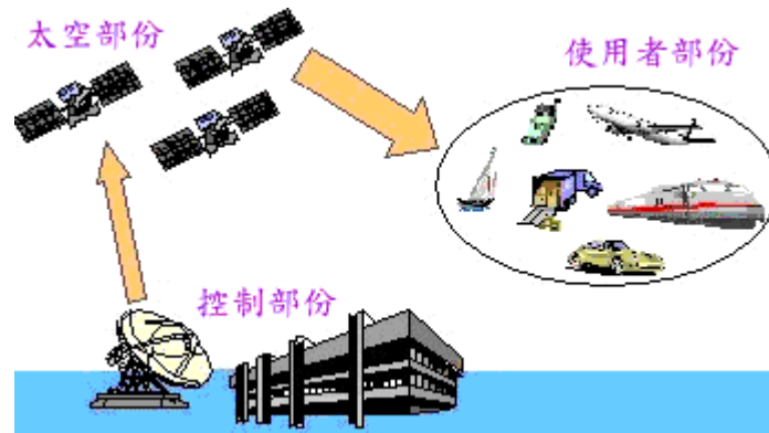
圖3.1 GPS系統架構示意圖
