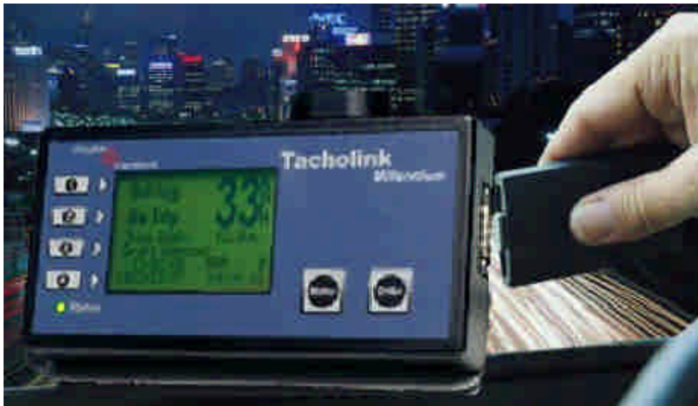
圖 3.10 澳洲 Circuitlink 公司之 Tacholink Millennium 數位行車紀錄器
