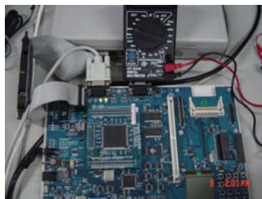
圖 5：以應用程式進行功率消耗所用之平台
