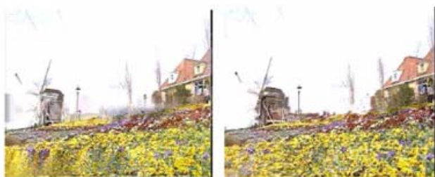
圖二十四 當第一個 I-frame 發生錯誤，分別用 JM(左)和所提出的演算法(右)錯誤補償後第 49 個 P-frame 的結果
