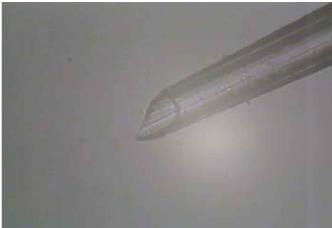
圖 2. 30 \mu\text{m} 斜尖口電灑噴頭(未導電塗佈)。拉尖侵蝕後，於 2000 番號的水砂紙上以斜角 30^\circ 先磨成斜口，再左右旋轉 90^\circ 磨成尖口。
