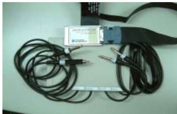
圖二、DAQ card、Cable 線、接線盒、信號線
