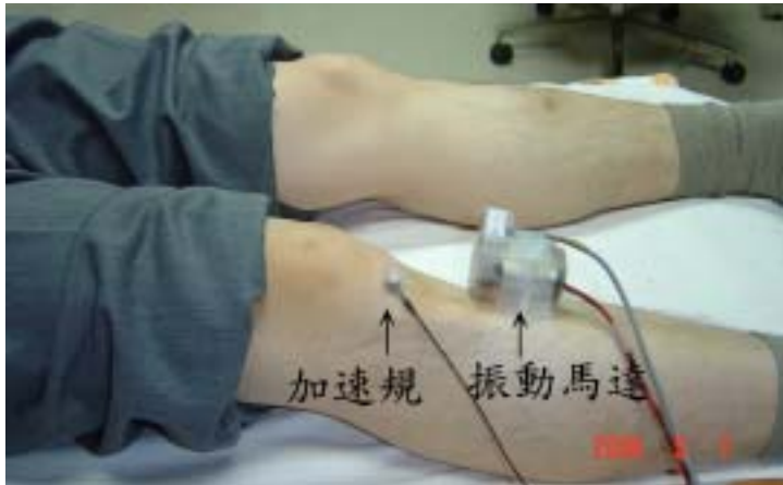
圖二：受試者以木架固定其膝關節角度，測量髕骨韌帶於 0 度，60 度及 90 度之自然頻率
