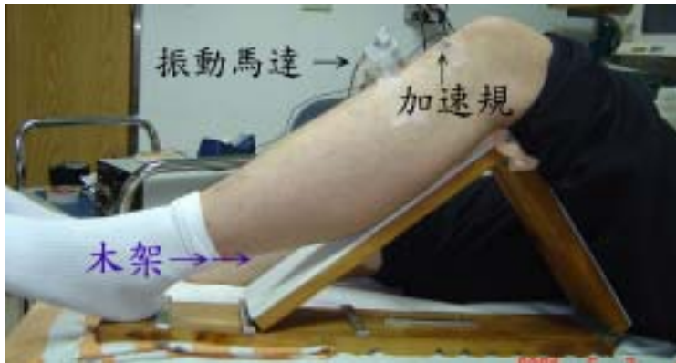
圖二：受試者以木架固定其膝關節角度，測量髕骨韌帶於 0 度，60 度及 90 度之自然頻率
