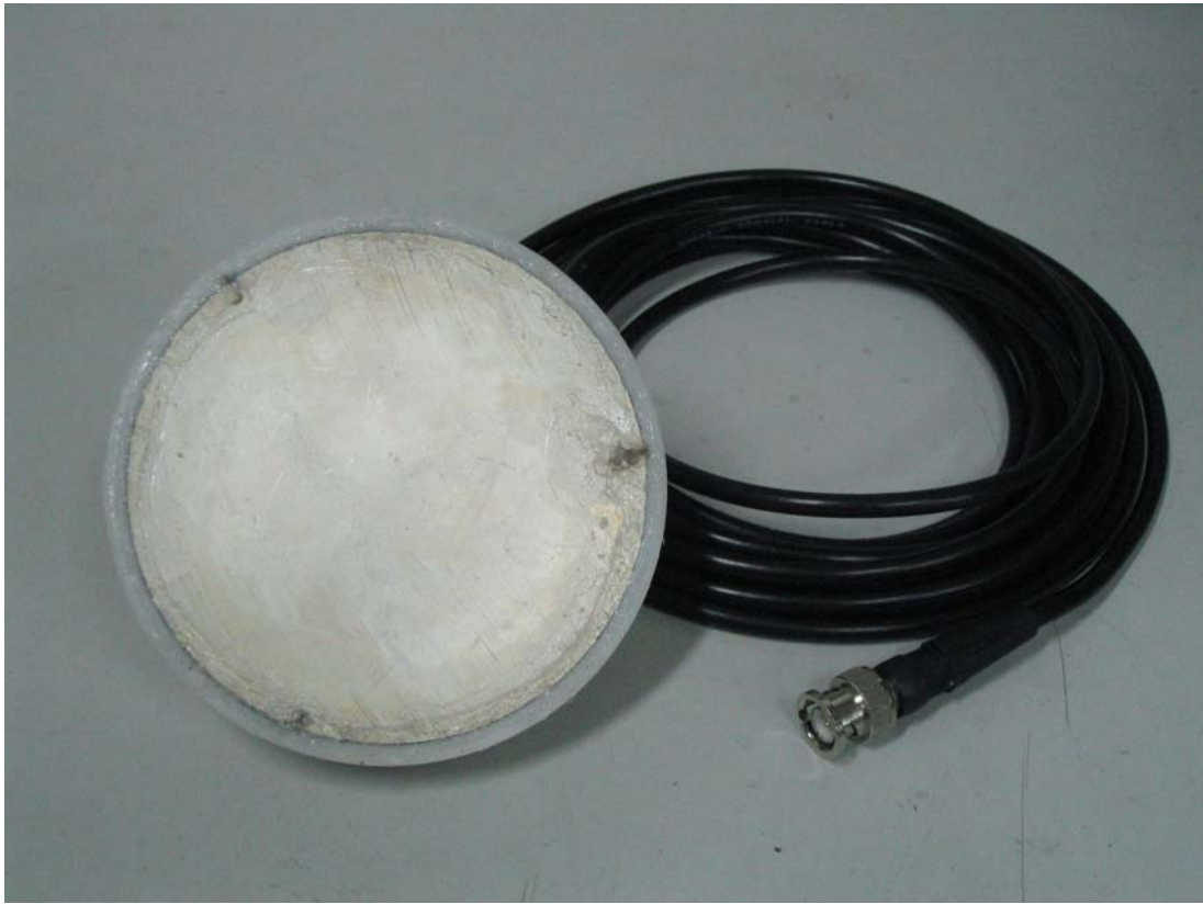
圖一：自製的磁振掃描(MRI)相容 HIFU 探頭
