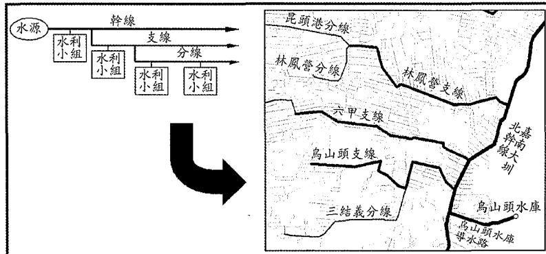
圖 1 灌溉渠道系統結構示意圖
