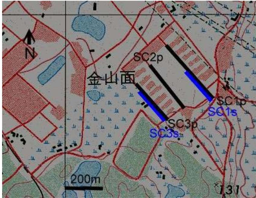
圖7、本次研究測區內的測線配置，測線以西北-東南走向配置，跨越圖6中之斷層線，包括3條P震測測線與2條SH波測線。
