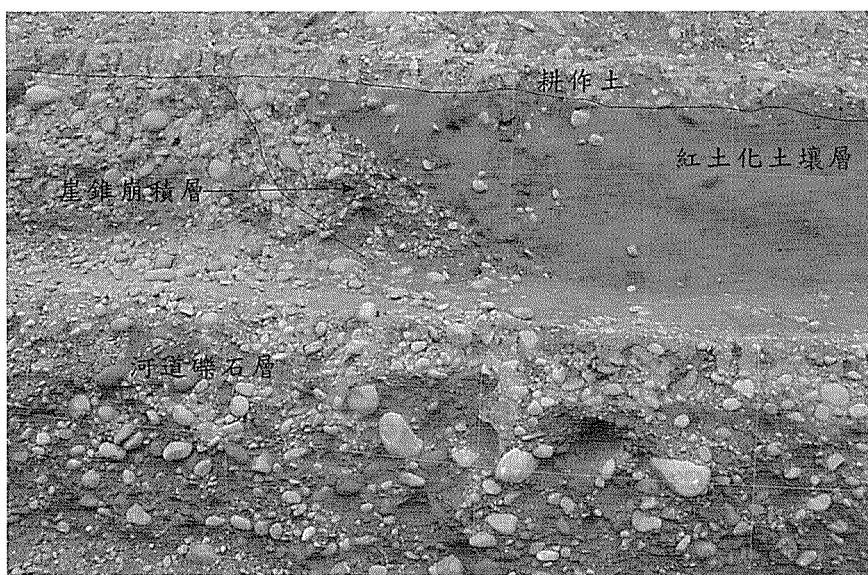
圖四 1號槽溝剖面，部為河道砾石層，砾石層受到斷層作用形成斷層崖，崖上形成一楔形的崖錐崩積層，之上為紅土層與耕作土。
