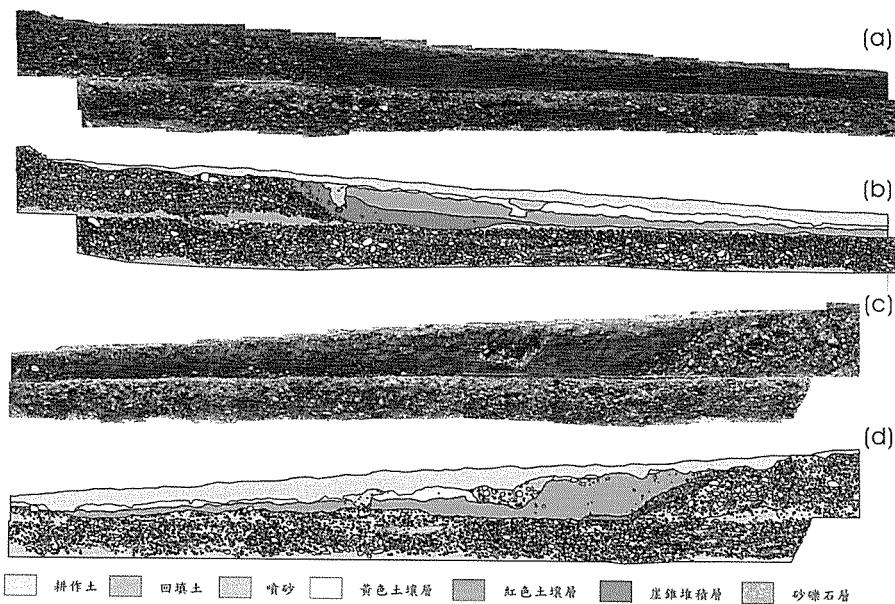
圖五 梅山斷層 1號槽溝面圖，a、b 為西牆剖面，c、d 為東牆剖面。
