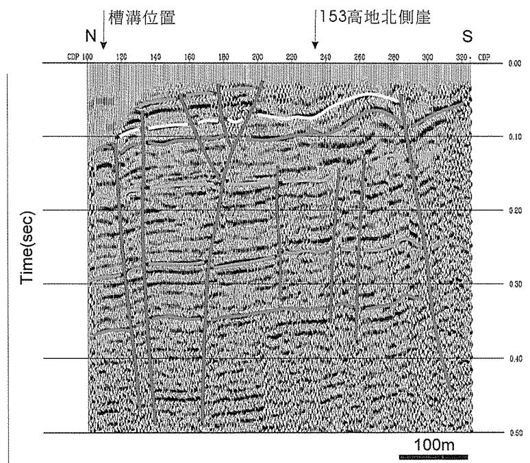
圖三 震測剖面顯示梅山斷層呈寬約數百公尺的擾動帶，槽溝位在測線最北側的斷層，153高地位在剖面南側地層被撓曲的位置。
