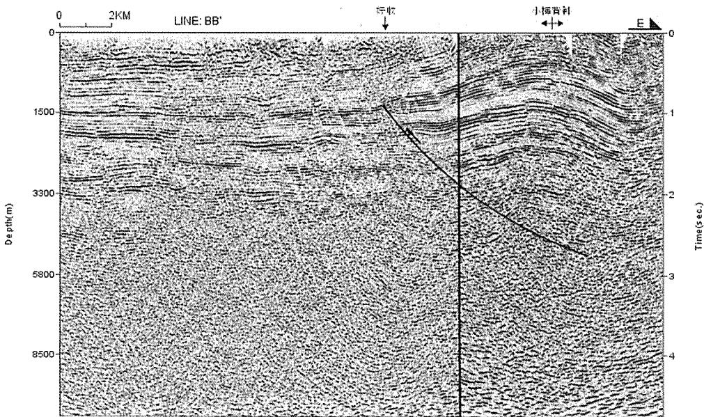
圖八 沿中正大學的紅土台地面呈東西走向的震側剖面，紅土台地位在小梅背斜的西翼，小梅背斜是受到嘉義斷層的逆衝作用所造成的褶皺構造，斷層延伸至地表的位置約在好收附近，亦即紅土台地隱沒至沖積平原之下的位置。
