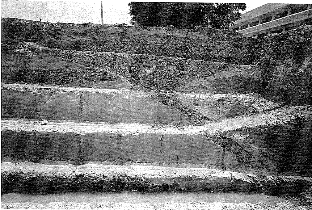
圖二 1號槽溝北牆的斷層帶,共有5階,卓蘭層逆衝到晚更新世的河流相砂礫層之上(洪如江教授攝)。
