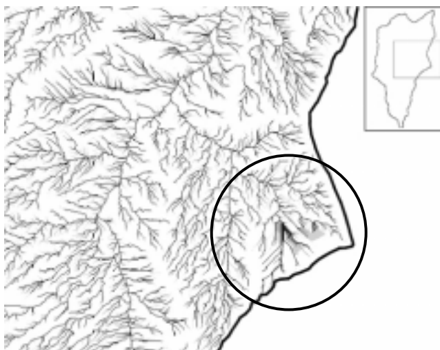
圖 7 5 公尺解析度單流向模擬結果
