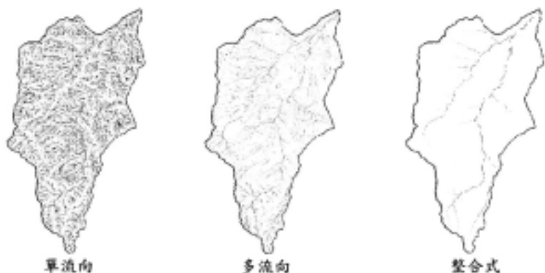
圖 6 5 公尺解析度集流面積分佈圖(全圖)
