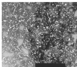
圖 4 經水熱處理後溶膠之 TEM 明視野影像
