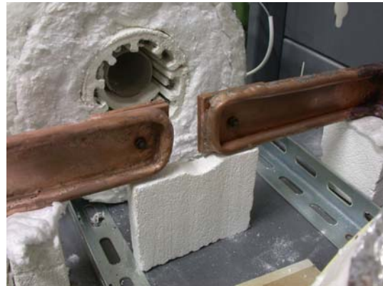
圖十七(b) 加裝蛇管後，銅片表面無氧化銅產生
