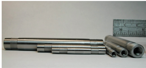
圖一：不同長度與直徑之圓桿疲勞試片
