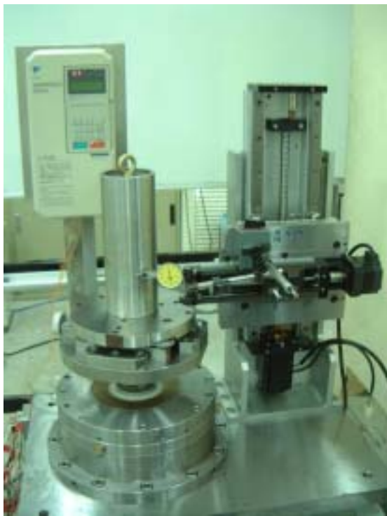
圖 七 (a)、整機 Z 軸精度檢測- 20\ \mu\text{m}
