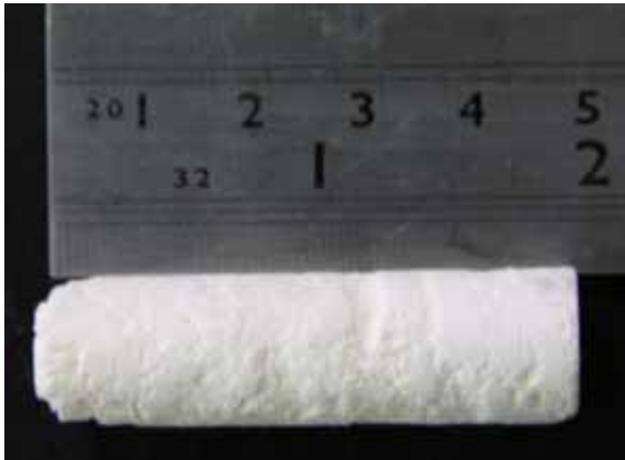
圖 5 表面有缺陷的高分子毛細結構
