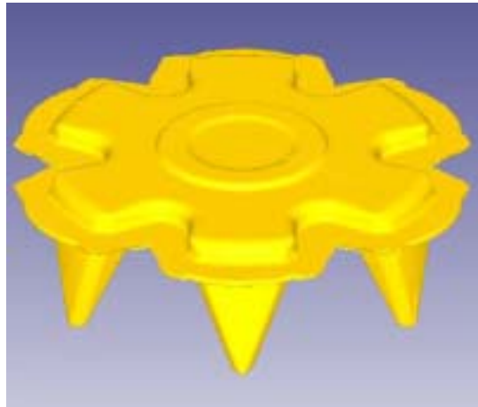
圖 12 完成鍛之模擬結果圖
