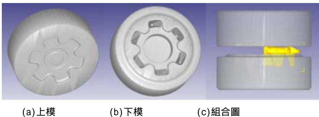
圖 7 成形鍛模具示意圖
