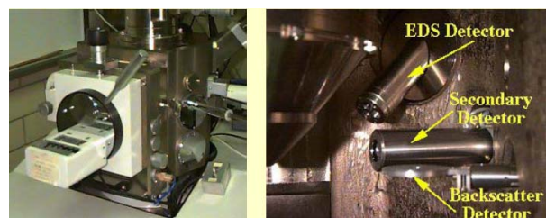
圖 2-1 掃瞄式電子顯微鏡之外觀構造
