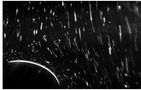
圖 5-10 所示為圓柱模型以 30fps 拍攝，其對應之實際尺寸 9 cm x 8.4 cm，Z=5 cm 處之俯示流場，(1)Re=19,300、(2)Re=27,600、(3)Re=35,900、(4)Re=44,200。
