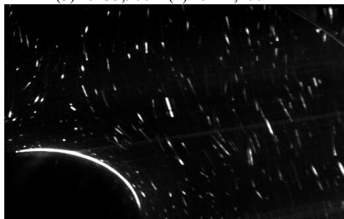
圖 5-9 所示為圓柱模型以 30fps 拍攝，其對應之實際尺寸 9 cm x 8.4 cm，Z=5 cm 處之俯示流場，(1)Re=19,300、(2)Re=27,600、(3)Re=35,900、(4)Re=44,200。
