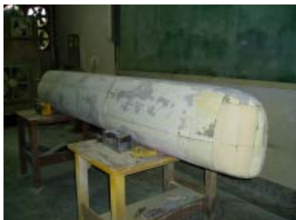
圖二 前、中段 FRP 外殼積層
