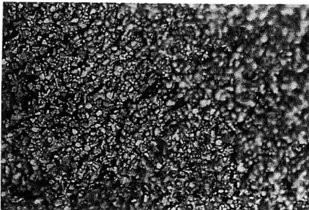
圖 3 錫酸鈉電解液下之電解析出試片顯微組織相片 (500 倍, 0.5mA/cm 2 24 小時)
