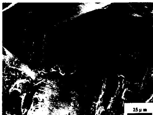
圖 4、B-700 試片於氫環境(20atm)下之脆性破斷
