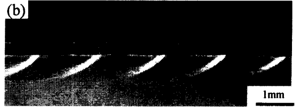
圖 5 雷射噴覆層橫斷面觀察(a) T-900 (b) S-306 與 T-900 混合粉末(1:1)
