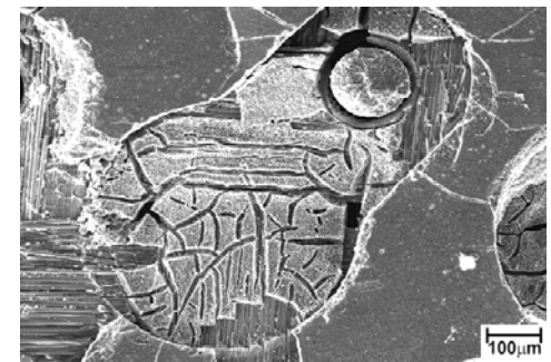
圖 9 (a) Sn-3.5Ag 錫球接點經 200°C 時效後，Ni 3 Sn 4 、(Au,Ni)Sn 4 與 Ag 3 Sn 三種介金屬同時生成；(b) Sn-3.5Ag 錫球接點經 200°C 1,000h 時效後 BT 基板及錫墊出現嚴重破損；(c) Sn-3.5Ag 錫球接點經 200°C 時效 1,000h 後的推球斷面，呈現錫墊剝離現象
