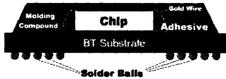
圖 3 PBGA 結構示意圖
