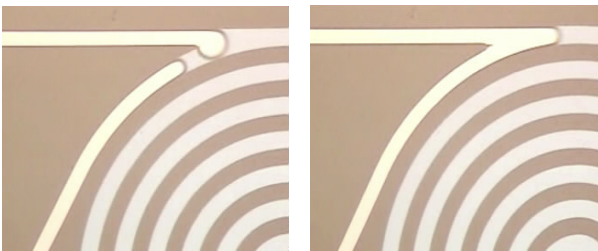
圖 4-5 腔體墊高高度 15\ \mu\text{m} 之液體致動流場
