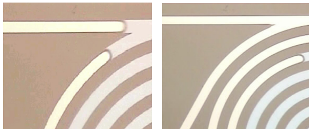
圖 4-6 腔體墊高高度 10\ \mu\text{m} 之液體致動流場
