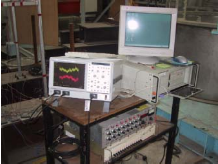
照片 6.5 衝擊載重試驗之儀器設備
