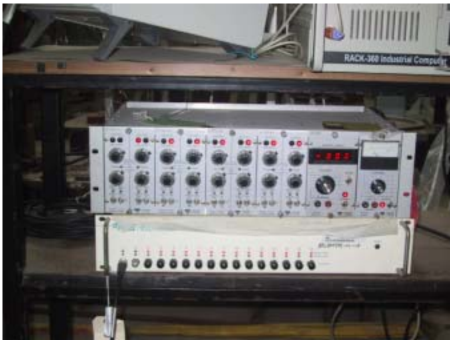
照片 6.7(a) 訊號調節放大器-惠斯敦電橋(前視)
