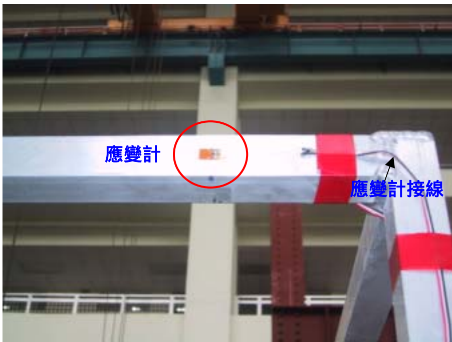
照片 6.4(b) 黏貼於鋁構架模型之應變計
