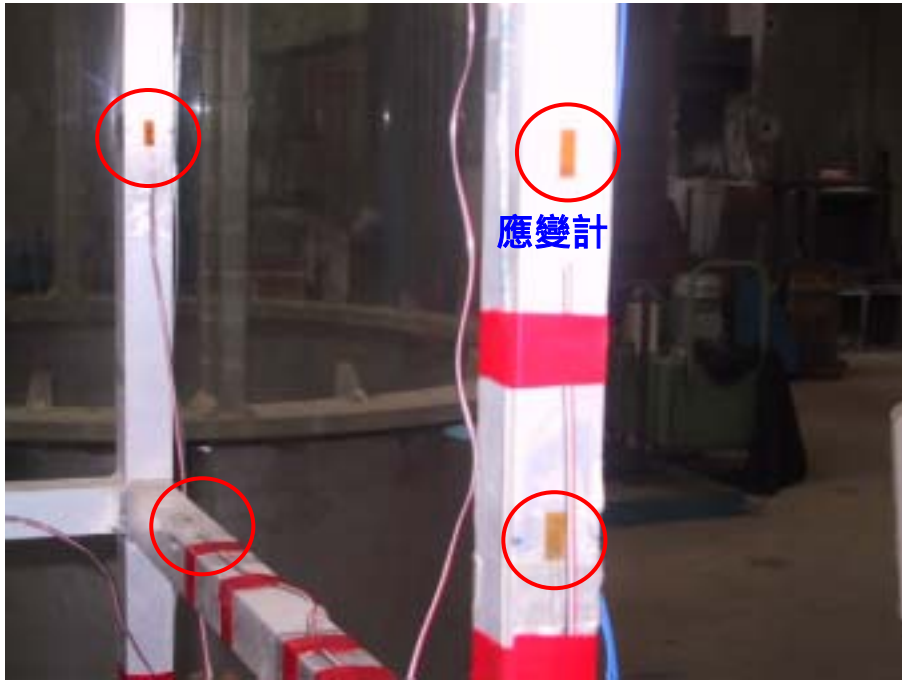
照片 6.4(a) 黏貼於鋁構架模型之應變計
