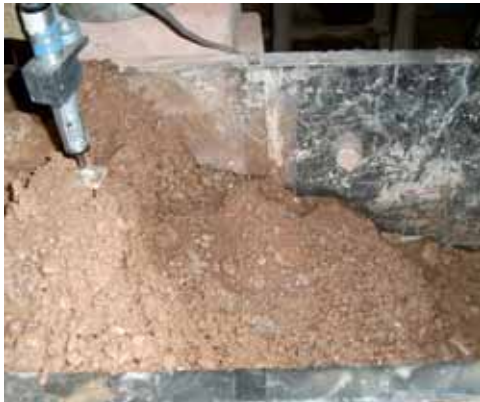
圖 4.9 第一組坡度 75° 土體崩塌情形
