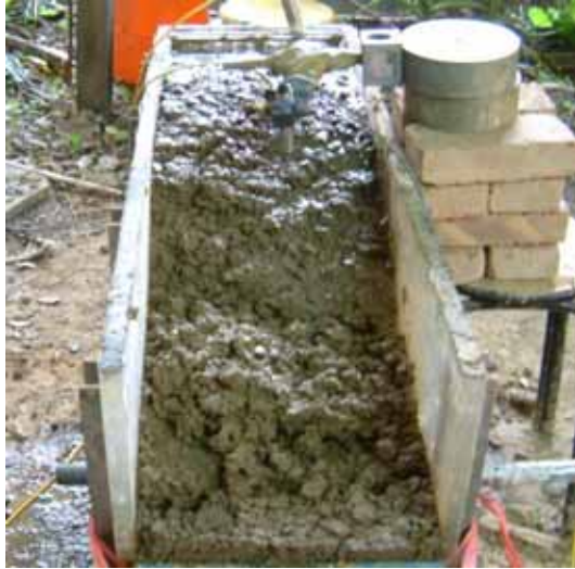
圖 4.7 第一組坡度 90° 土體崩塌情形
