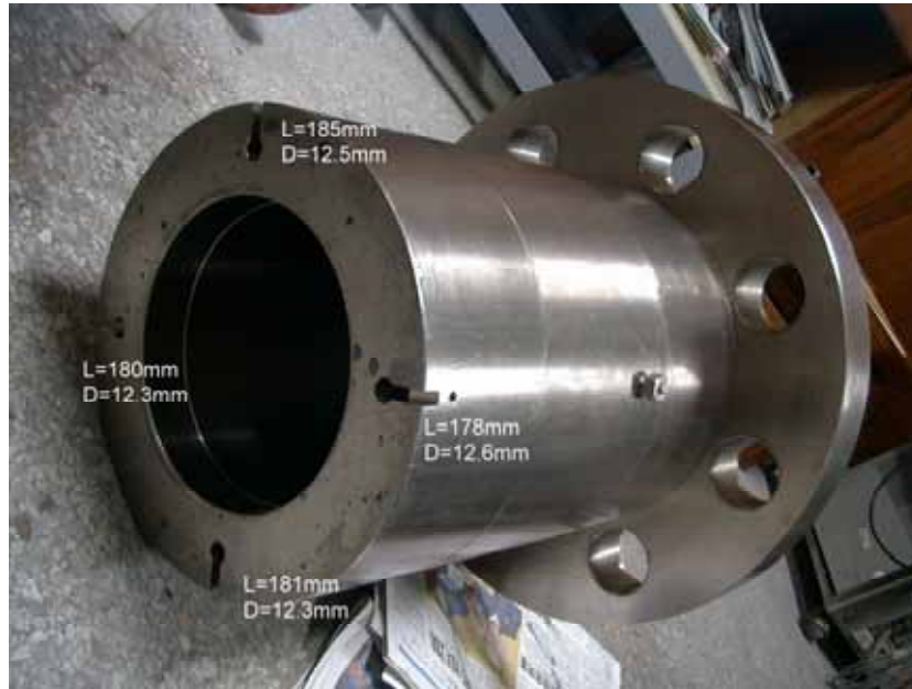
圖 3 三軸筒之外蓋，底部四個孔洞為加熱棒之放置處。
