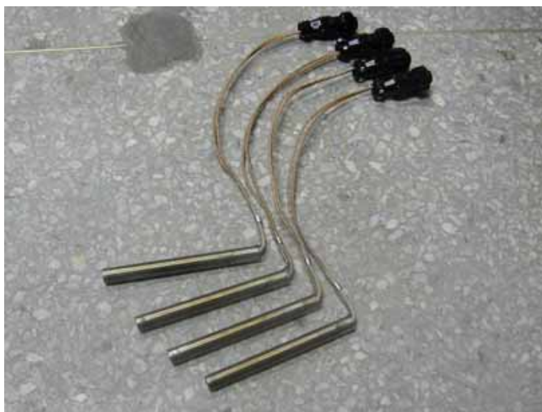
圖 2 三軸加溫系統之加溫棒
