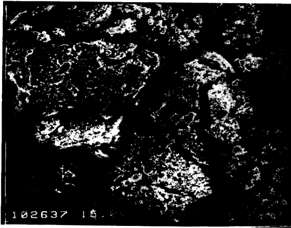
圖 (7) 退化(degradation)合金極的 SEM
