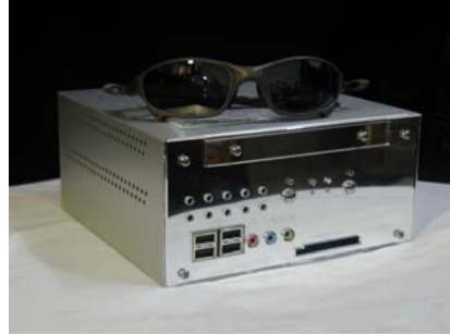
圖 4 本研究實作之智慧型接取點，外殼大小為 18cm*18cm*8.5cm，內部使用 Intel Pentium-M 2.0G Dothan 的 CPU、512Mb 的記憶體並配備 Senao NL-2511CD PLUS 802.11 b 無線區域網路卡。
