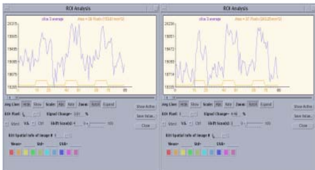
圖 6. 視覺反應區的信號變化情況 (a)原廠預設值得到之影像，其視覺反應區的信號變化是 3.91%。(b).自動調整參數得到之影像，其視覺反應區的信號變化是 4.46%，且波形也比較接近完整的方波。
